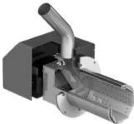
2. Ábra. Pell Eco égő szerkezete
